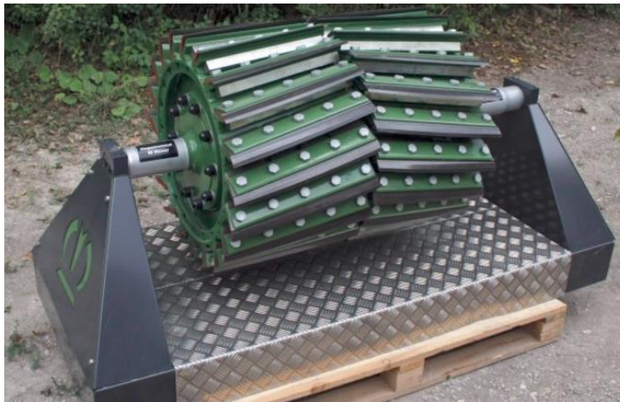
Et eksempel på en knivcylinder. Modholdet er ikke vist på dette billede
